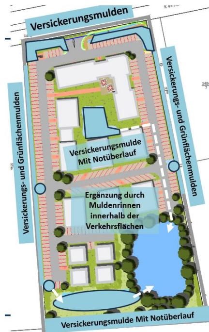
Abbildung 14: Schematische Darstellung Entwässerungskonzept (Stand: 08/2024)
